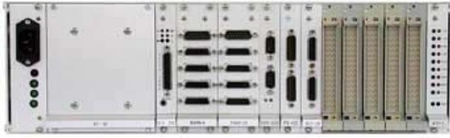
Typische Konfiguration einer ECB-Steuerung der 80er Jahre mit 8 geregelten Achsen (PosiStop).
