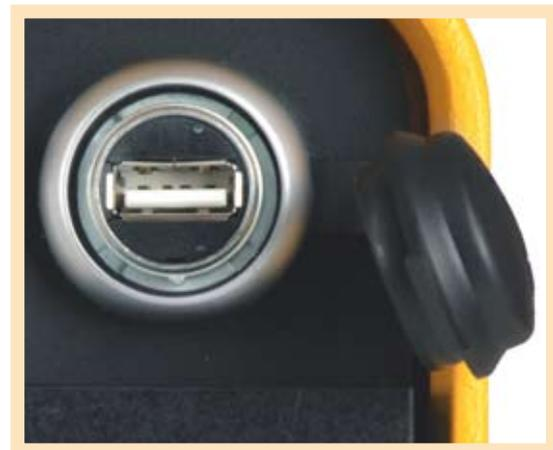
Beim **LINK-Bedienterminal** haben Sie den Vorteil, **keine ADOS formatierten Disketten** mehr zu benötigen, da die über das Laufwerk eingelesenen Daten nun alle auf dem USB-Stick gespeichert werden können.
