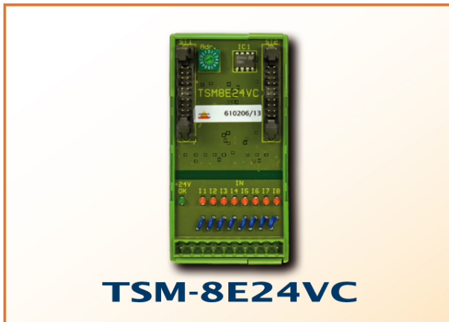
TSM-8E24VC 8 digitale Eingänge für parallelen Systembus, kurzschlussfest
